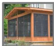
Galerie ou balcon couvert, protégé par des moustiquaires et disposé en saillie à l'extérieur d'un bâtiment, non utilisé comme pièce habitable non isolée et ne comportant aucun système de chauffage. La véranda peut comprendre 50 % de murs fermés et doit avoir 50 % de moustiquaire. Les murs de la résidence ne sont pas pris en compte dans le calcul du pourcentage. (Certificat d'autorisation nécessaire).
